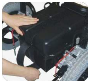
8. Desabroche el velcro de la base de la caja de baterías.
