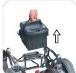
8. Sostenga la batería por la correa y levántela.
