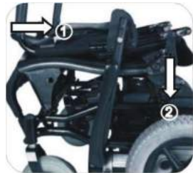
4. Pliegue el respaldo hacia delante y presiónelo.
