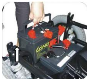
11. Levante la batería por sus agarraderas.
