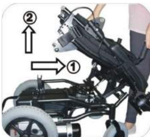
7. Tire del asiento hacia arriba y hacia delante para levantarlo.
