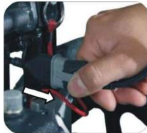
5. Desconecte el cable del conector de transmisión
