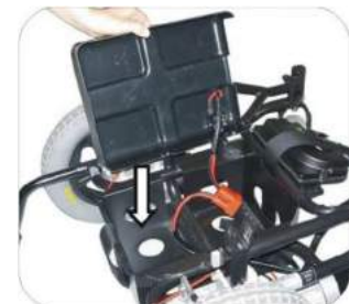
12. Después de sacar las baterías cierre la tapa de caja de baterías.
