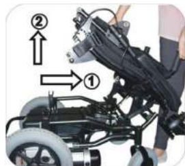
7. Tire del asiento hacia delante y hacia arriba para desmontarlo.
