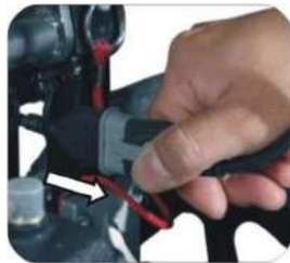
5. Desconecte el cable del conector de transmisión.
