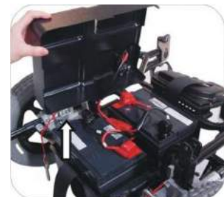
9. Abra la tapa de la caja de baterías (a la izquierda).
