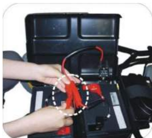
10. Desconecte la batería.
