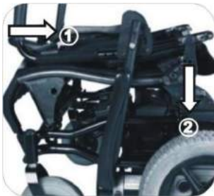
4. Pliegue el respaldo hacia delante y presiónelo.
