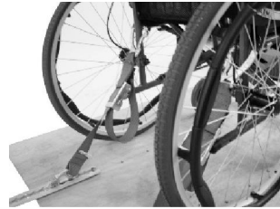
Fijando anclaje trasero
